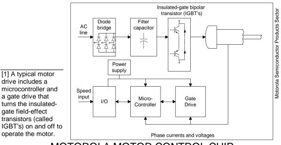
MOTOROLA MOTOR CONTROL CHIP
