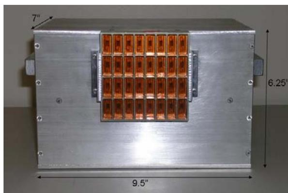
Fig. 6. Complete MWVR radiometer.
